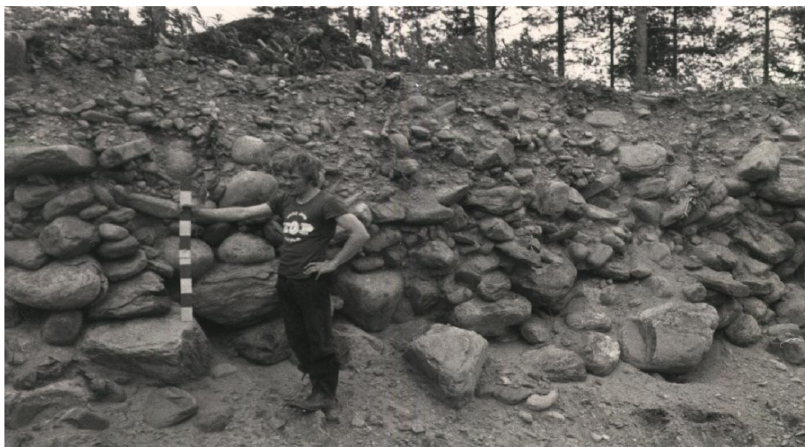
Kuva 1. Pääluokkaan A) kuuluvaa materiaalia harjuleikkauksessa. A) materiaalin osuus n. 70 %, pintaosa kivistä soraa. Ylisuuria lohkaraita n. 5 %. Kuva julkaisun (Geologian tutkimuskeskus 1973) liitteestä.
