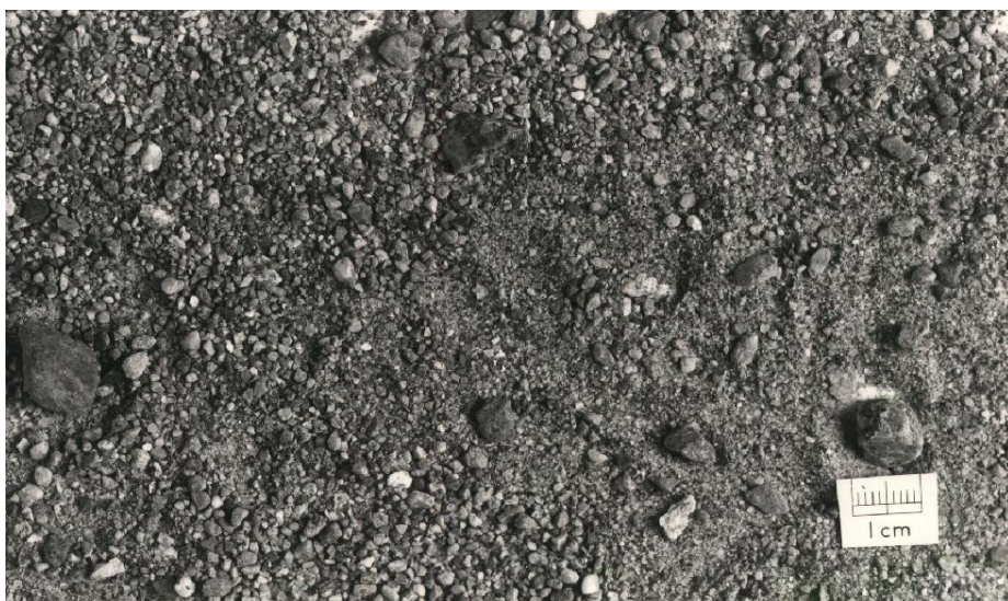
Kuva 3. Pääluokkaan C) kuuluvaa hiekkavaltaista ainesta. Soran osuus aineksessa n. 10 %. Loput on hiekkaa. Kuva julkaisun (Geologian tutkimuskeskus 1973) liitteestä
